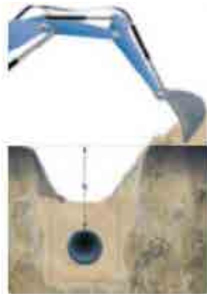
Afb. 2-2 Standaardbuizen worden in een zandbed gelegd.
