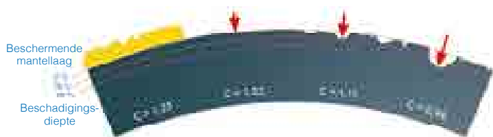
Afb. 2-18: Beschouwing van de veiligheidsfactor C in relatie tot de groefdiepte
