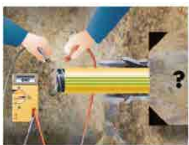
Afb. 2-27: Continuïteitscontrole als bewijs van het intact zijn van de nieuwe buisleiding
