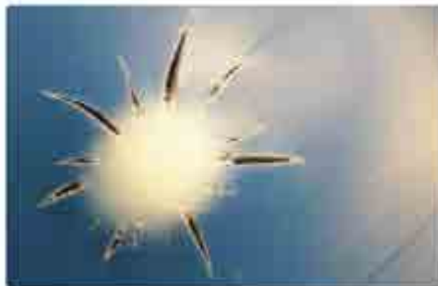
Afb. 2-21: Spanningsbreuk aan de buisbinnenzijde als gevolg van puntlasten bij een verkeerde materiaalkeuze (Bron: HESSEL Ingenieurtechniek)
