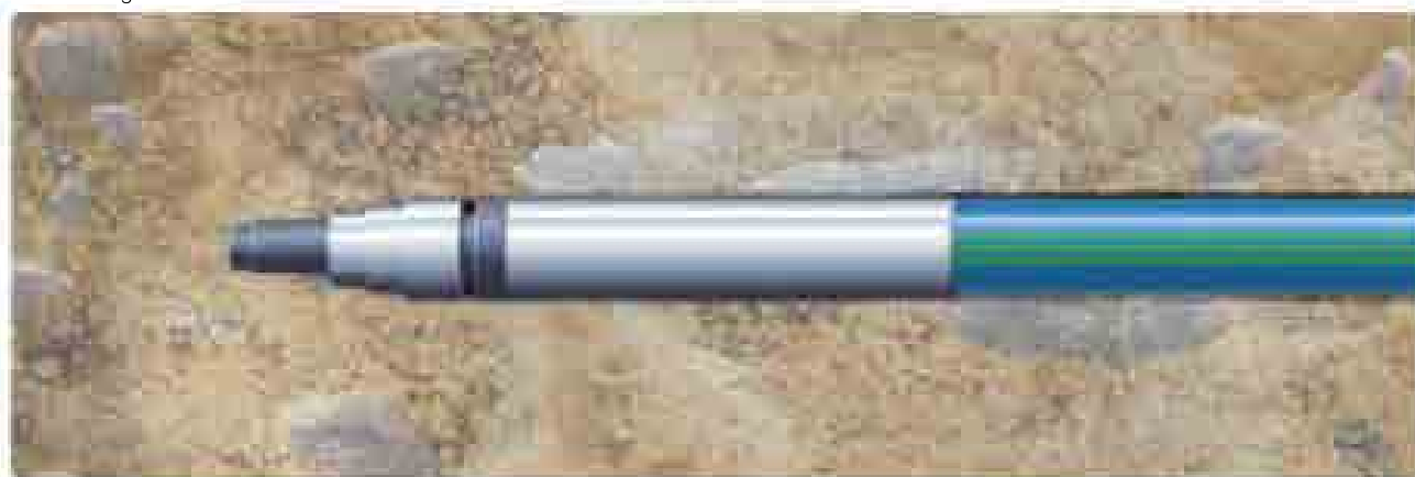
Afb. 2-6: Bij installatie met een grondraket kan de „ingesloten“ leiding worden beschadigd. Daarom is het gebruik van buisleidingen met extra beschermlagen vereist.
