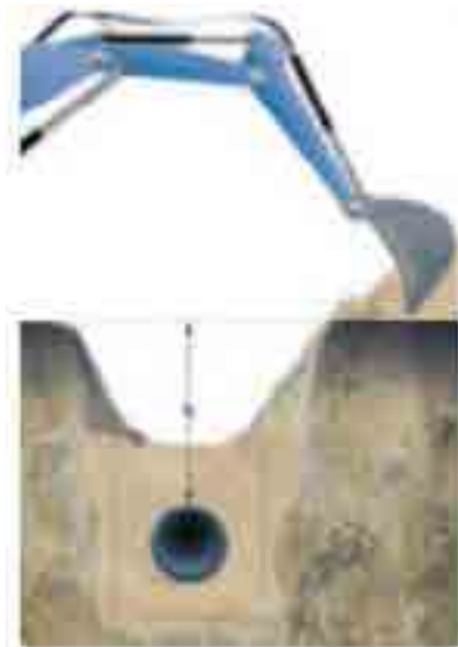
Afb. 2-2 Standaardbuizen worden in een zandbed gelegd.
