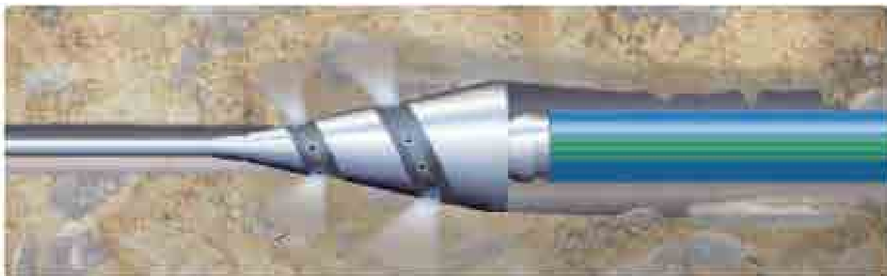
Afb. 2-9: Bij installatie op basis van de HDD-methode kan de leiding worden beschadigd. Daarom is het gebruik van buisleidingen met extra beschermlagen vereist.
