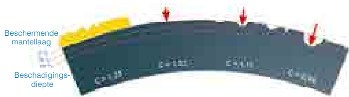
Afb. 2-18: Beschouwing van de veiligheidsfactor C in relatie tot de groefdiepte
