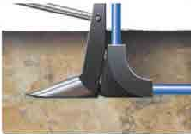
Afb. 2-4: Bij installatie met de ploeg wordt het gebruik van buisleidingen met geïntegreerde beschermlagen aangeraden.
