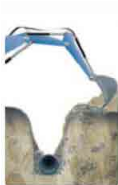
Afb. 2-3: Wanneer er geen zandbed wordt gebruikt, wordt het gebruik van buisleidingen met geïntegreerde beschermlagen aanbevolen.
