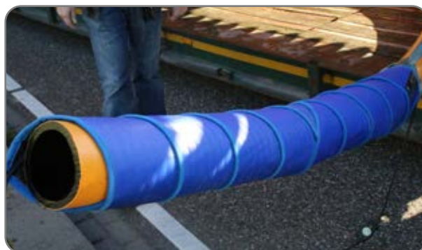
Powerschraper voor buis dia. 315 t/m 1400 mm
